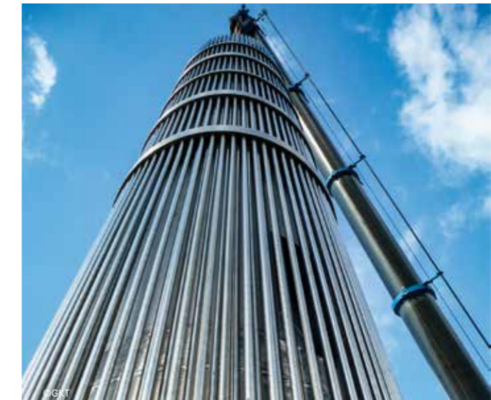
Kurzwegverdampfer mit integriertem Kondensator
